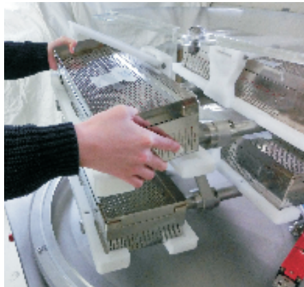
Trays in Trayaufnahmen positionieren Trayverriegelungen schließen
